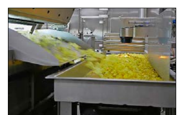
Der Optisorter selektiert die zu dunklen Chips.
